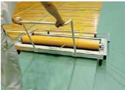
ラップ 10 機能によりフロアシートを 10cm 重ねて敷くことができるので美しい敷設と容易な作業が可能です。巻取時もサーボローラにより左右プレを解消します。
