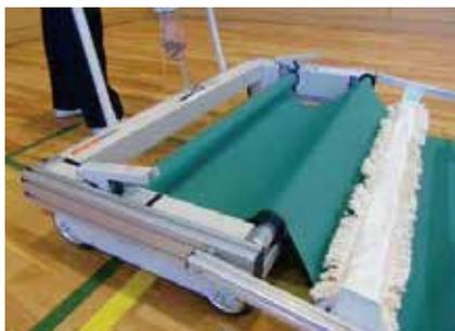
ERM 巻取機モップ搭載モデルではフロアシート撤収時に巻取をしながら同時にシート表面をモップで掃除することが可能です。モップが汚れたら、本体より取り外し水洗いすることで何度でも使用が可能です。
